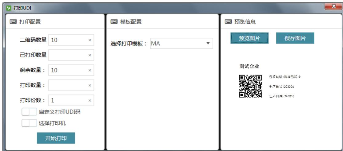
页面显示 UDI 标签生成数量，已打印数量和剩余数量，输入本次要打印的数量，并选好标签打印模板，单击【开始打印】，程序开始打印。
